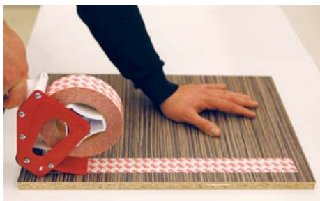
Приклеить двухстороннюю ленту (вручную, или с помощью держателя)
