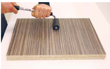
На места склеивания действуем соответствующим давлением с помощью ролика или другим подходящим способом
