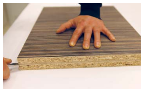
Соединение мгновенно схватывается, склеенную деталь можно сразу обрабатывать
