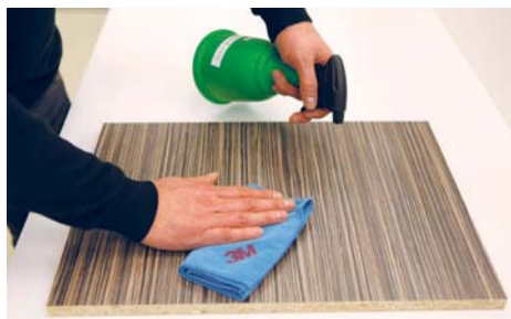
Склеиваемые поверхности очистить и обезжирить подходящим средством
